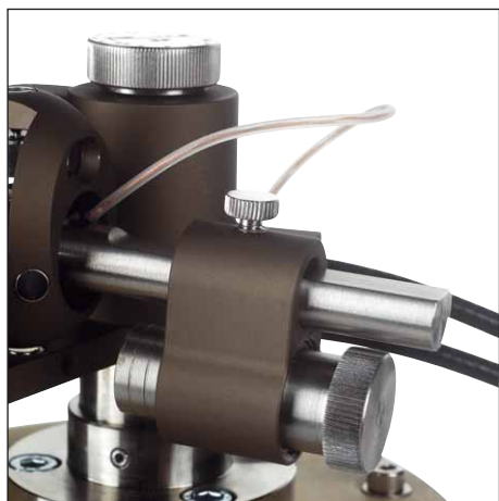
Das zweiteilige, tief hängende Gegengewicht erlaubt die feinfühlineg Einstellung der Auflagekraft
